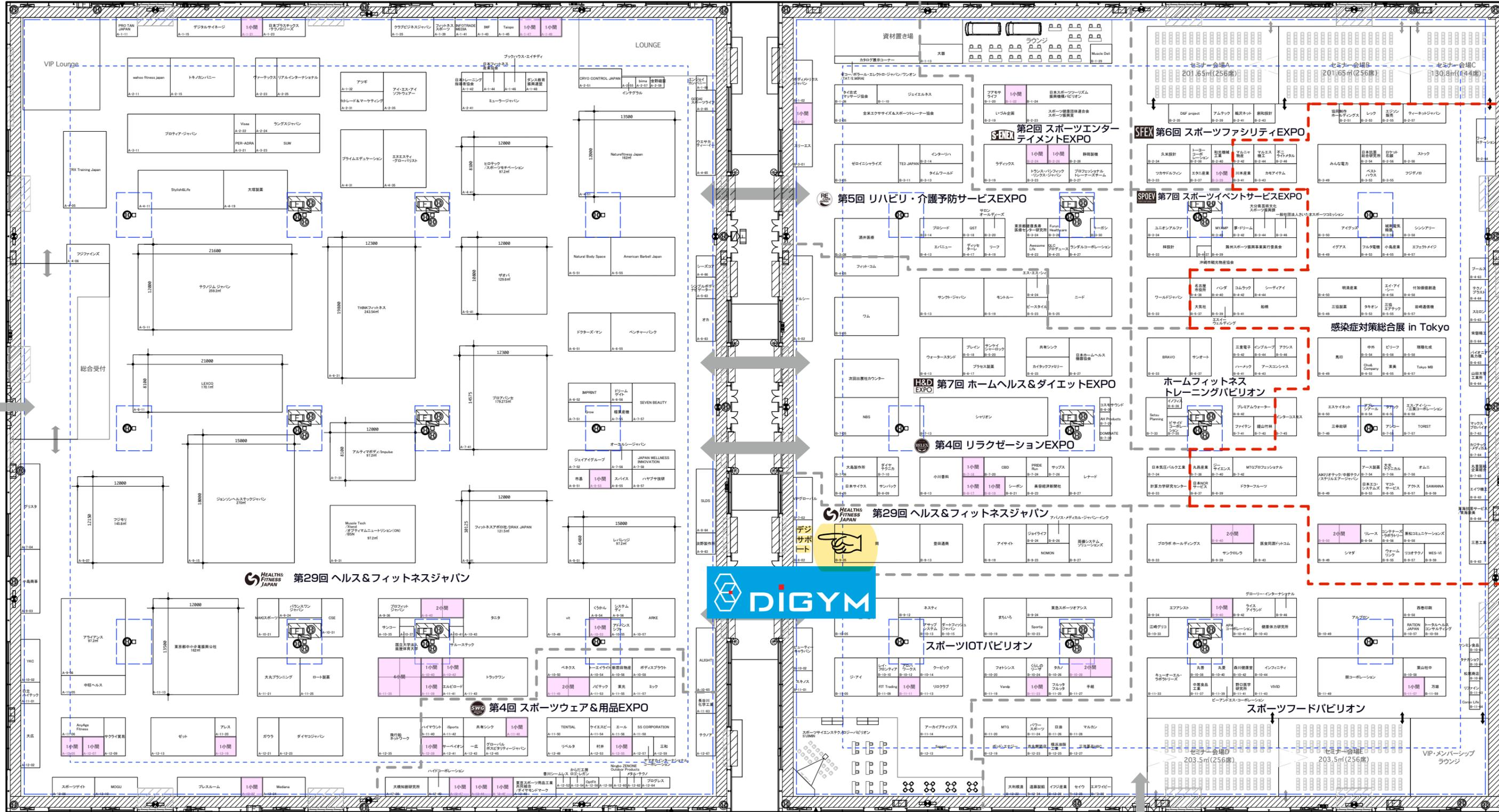
※ 点線枠内は耐荷重350kg/m<sup>2</sup>になります。
